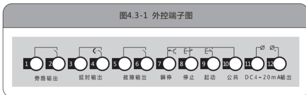
端子1、2用于控制旁路接触器,为无源动合触点,启动成功时闭合。
