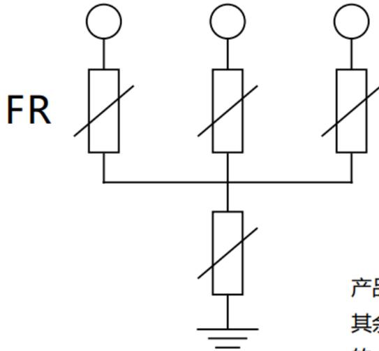
产品标有符"⊥"号单元接地线，其余三相分别接被保护电气设备的A、B、C即可。
